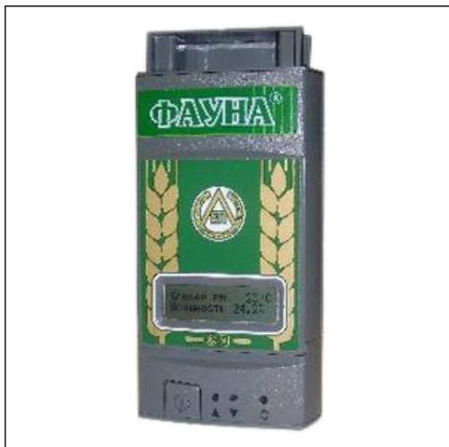
Измеритель Фауна-ВЛК предназначен для измерения влажности растительной массы, в том числе зерна в полевых условиях при уборке, сушке, переработке и при размещении для хранения и в процессе хранения, когда необходим экспресс-анализ влажности.
