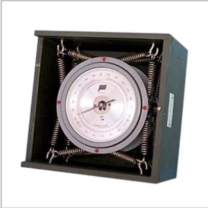
Барометр-анероид контрольный М-67 предназначен для измерения атмосферного давления в диапазоне от 610 до 790 мм рт. ст. в наземных условиях для работы в помещениях при температуре -10...+50°С и относительной влажности до 80%.
