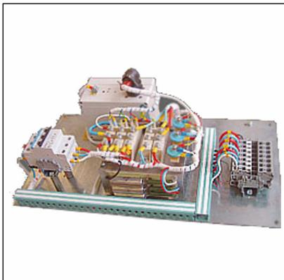
Преобразователь электропривода открывания днища ковша карьерного экскаватора **ПДК** обеспечивает равномерное натяжение троса открывания днища ковша экскаватора. Замена контакторов и резисторов привода "дергача" экскаваторов ЭКГ-8, (-10,-12,5,-15,-20 и др.).
