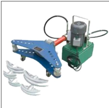
Электрогидравлический трубогиб ТГЭ-3 применяется в сантехнической сфере, а также для монтажа систем отопления и климатических систем. Используется при внутренней отделке помещений и на некоторых этапах машиностроительного производства.
