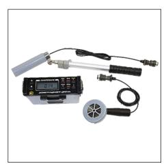
Назначение дозиметра ДРБП 03: рабочее средство измерения эквивалентной дозы и мощности эквивалентной ионизирующего фотонного излучения, а также плотности потока α-, β- излучения.
