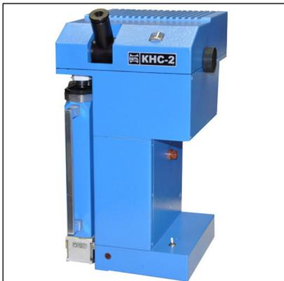
Колориметр **КНС-2** предназначен для инструментального оснащения ГОСТ 25337 и используется для определения цвета парафинов.
