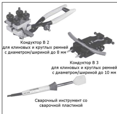
Для изготовления бесконечного ремня материал «сваривается», и, следовательно, возможно производство ремней любой длины. Для точного процесса соединения необходимы кондуктор и сварочный инструмент, включая сварочную пластину.
