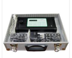
Прибор экологического контроля "Биотокс-10М" предназначен для быстрого количественного контроля степени интегральной токсичности проб воды и водных вытяжек, спиртов, воздушной среды, почвы, а также отдельных химических соединений, материалов, включая полимеры, для медицинских, санитарногигиенических и экологических целей. В основу работы прибора положен биолюминесцентный анализ.
