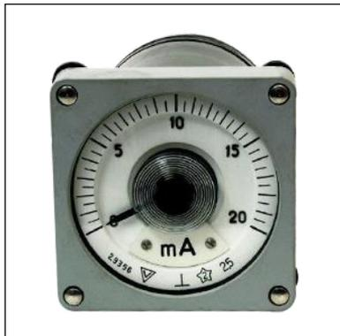
Амперметры и вольтметры M1420 предназначены для измерения тока и напряжения в сетях постоянного тока судовых энергетических установок, а также для работы в тяжелых условиях эксплуатации на предприятиях различных отраслей промышленности.
