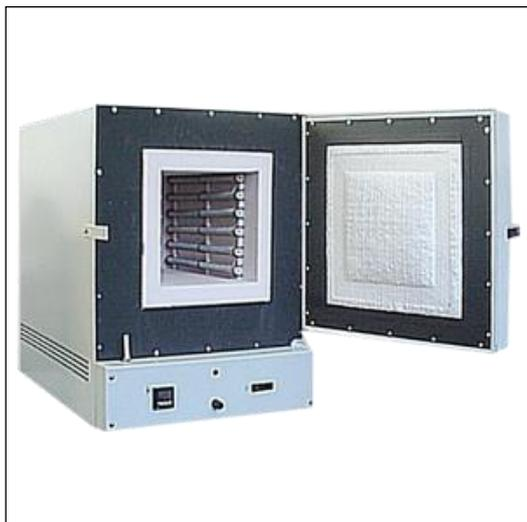
Высокотемпературная лабораторная электропечь SNOL 30/1300 предназначена для сушки и термообработки различных материалов в воздушной среде при температуре от 50 °С до 1300 °С.
