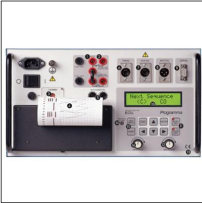
Система **Megger EGIL** предназначена для тестирования и проверки выключателей на распределительных и небольших сетях электроснабжения, и рассчитанная на среднее напряжение (до 220 кВ) не более чем с одним контактом на фазу.
