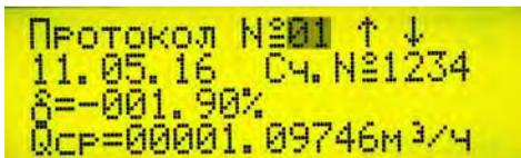
При просмотре протоколов круговое зацикливание (переход от 99 номера сразу к номеру 00) отсутствует, при этом нельзя подняться выше протокола с №99 (или последнего записанного) или опуститься ниже протокола с номером №00.
