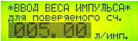
В данном окне необходимо, используя цифровую клавиатуру, задать вес импульса, например 5,00 л/имп., указанный на поверяемом счетчике (для счетчиков с импульсным выходом) и подтвердить правильность ввода нажатием на кнопку «ВВОД». Как правило, вес импульса для счётчиков, имеющих импульсный выход, равен 1/10/100 л/имп.
