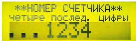
Используя цифровые кнопки ввести четыре последние цифры заводского номера поверяемого счетчика и, нажимая на кнопку «ВВОД» подтвердить правильность выполненного ввода, после чего нажать на кнопку «СБРОС» и перейти в меню «Поверка».
