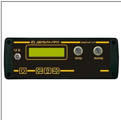
Измеритель переходного затухания **Дельта-ПРО 2.0** служит для измерения и допускового контроля переходного затухания между цепями линий передачи местных первичных телефонных сетей и низкочастотных линий передачи внутризоновых и магистральных первичных сетей на частотах 800 Гц, 1020 Гц или 1200 Гц.
