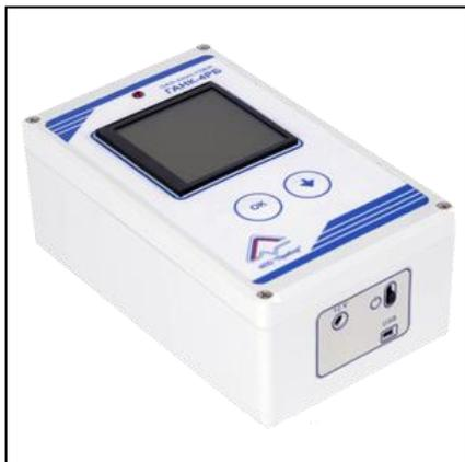
Газоанализатор ГАНК-4РБ предназначен для автоматического одновременного измерения концентрации до восьми загрязняющих химических веществ (ЗХВ) с помощью встроенных датчиков, например: аммиака ( $\text{NH}_3$ ), бензола ( $\text{C}_6\text{H}_6$ ), диоксида азота ( $\text{NO}_2$ ), диоксида серы ( $\text{SO}_2$ ), оксида углерода ( $\text{CO}$ ), сероводорода ( $\text{H}_2\text{S}$ ), суммы углеводородов ( $\text{C}_m\text{H}_n$ ) и формальдегида ( $\text{HCHO}$ ).
