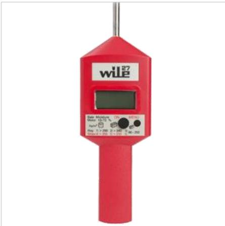
Влагомер WILE-27 предназначен для оперативного измерения влажности сена в брикетах, валках, силосе.
