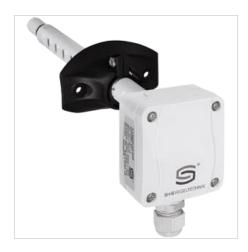
Датчик KFTF-U-NTC10K-PLEURO предназначен для измерения относительной влажности и температуры воздуха. Результаты измерений преобразуются в нормированный сигнал 0–10 В или 4...20 мА. Датчик позволяет переключаться между четырьмя диапазонами измерения температуры и находит применение в неагрессивной среде без содержания пыли, в холодильной технике, системах вентиляции и кондиционирования, оборудовании для особо чистых и стерильных помещений.
