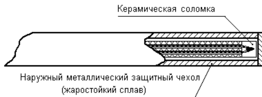
Конструкция рабочей зоны термопреобразователей ТППТ(ТПРТ) 01.06, D = 7
