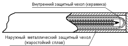
Конструкция рабочей зоны термопреобразователей ТППТ(ТПРТ) 01.06 и 01.16, D = 10, 20, 27 мм
