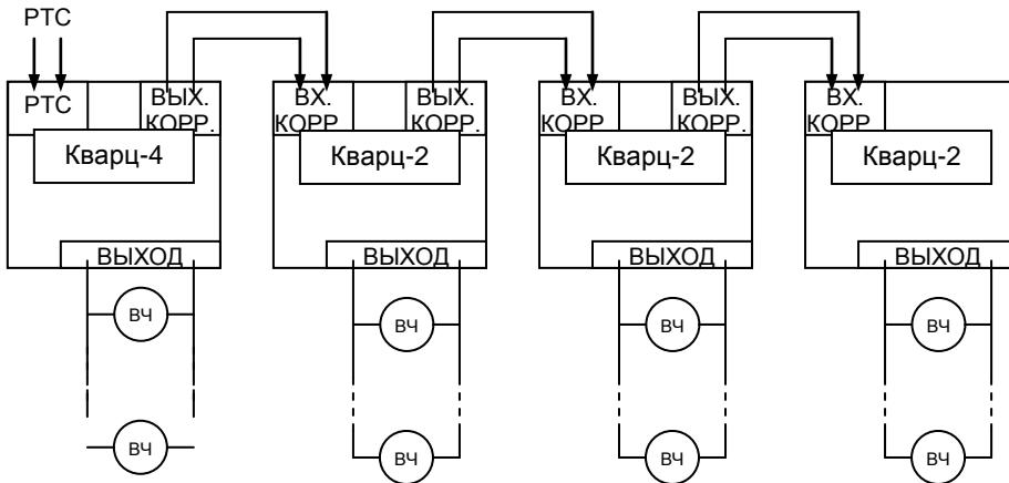
Суммарное сопротивление 2-х проводов между контактами «ВЫХ.КОРР.» предыдущих первичных часов и контактами «ВХ.КОРР.» последующих должно быть не более 150 Ом (800 м провода сечением 0,2 мм<sup>2</sup>).
