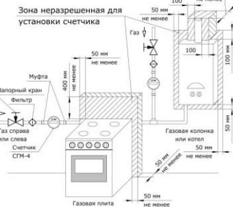
6.4 Для соблюдения требований условий эксплуатации, приведенных в п.9 таблицы 1, **не рекомендуется** установка счетчика на расстоянии от края бытовой плиты или иного газоиспользующего оборудования менее 400 мм по высоте и 50 мм по ширине (справа или слева) и глубине.
