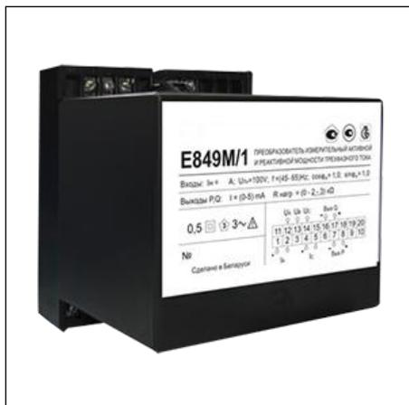
Измерительные преобразователи типа Е849М предназначены для линейного преобразования активной и реактивной мощности трехфазных трехпроводных цепей переменного тока в два гальванически развязанных между собой унифицированных аналоговых выходных сигнала постоянного тока.
