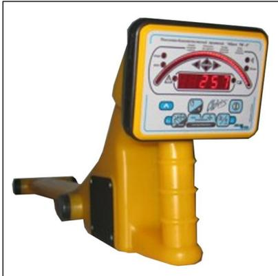
Трассопоисковый приемник многочастотный **ТМ-8** (трассоискатель) служит для определения положения и глубины залегания подземных металлических трубопроводов и кабелей. Приемник может использоваться как совместно с генератором ТГ-ХХ, так и автономно - для обнаружения городских коммуникаций в пассивном режиме.
