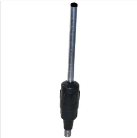
Ареометр АБР-1М предназначен для определения плотности буровых или любых других растворов, а также жидкостей и пульп, нейтральных к полиэтилену.
