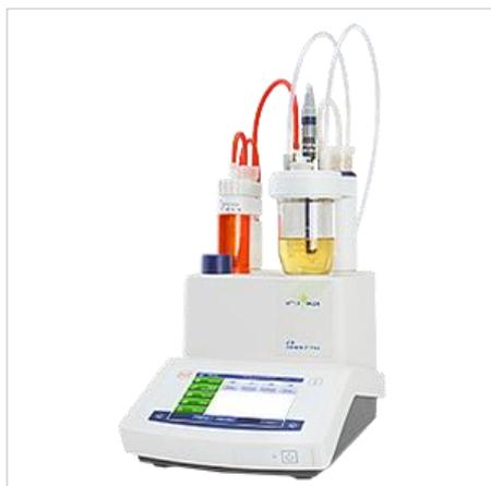
Компактный волюмометрический титратор по методу Карла Фишера V10S прост в эксплуатации и идеально подходит для быстрого и точного определения содержания воды. Образцы с содержанием воды от 100 млн-1 до 100 % анализируются как по отдельности, так и сериями со статистической обработкой результатов
