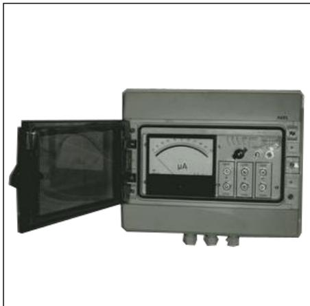
Устройство КИТ-110-330 предназначено для непрерывного контроля состояния изоляции трансформаторов тока 110 кВ и выше, высоковольтных вводов и оборудования с бумажно-масляной изоляцией конденсаторного типа под рабочим напряжением.
