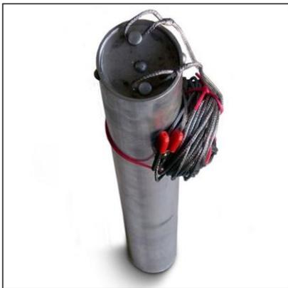
Пробоотборники **ППМН, ППМА** служат для отбора проб нефти и нефтепродуктов из резервуаров, нефтеналивных судов, подземных хранилищ, железнодорожных цистерн, бочек и иных средств хранения и транспортировки.
