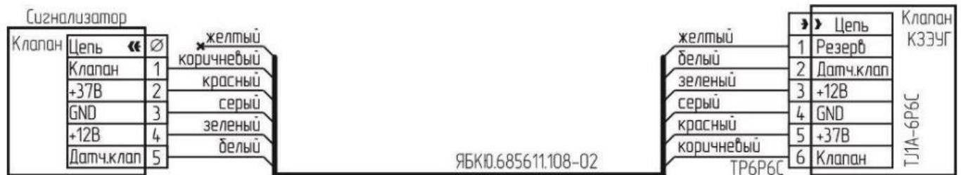
Рис. 14. Схема подключения клапана К3ЭУГ с разъемом TJ1A-6P6C
