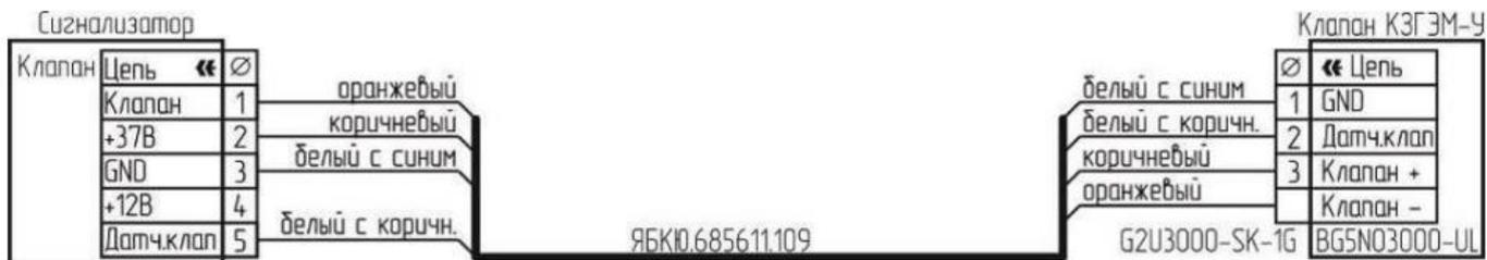
Рис. 13. Схема подключения клапана К3ГЭМ-У с разъемом BG5NO3000-UL
