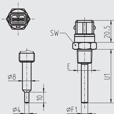
**Разъём с плоским контактом
