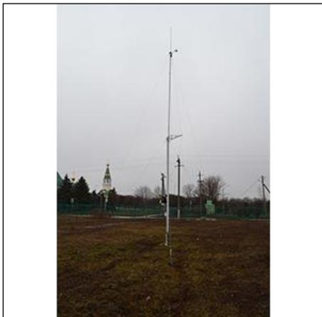
Мачта метеорологическая М-82 ИЛАН.301317.004 предназначена для установки на ней датчика ветроизмерительного прибора типа анеморумбометр М-63М-1 (или его модификаций), ее эксплуатируют при температуре от -50 до +45 °С и относительной влажности 100% при температуре 25 °С.
