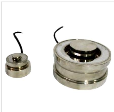
Цилиндрические датчики предназначены для использования в многотонных весах: вагонных, автомобильных, бункерных. Также датчики цилиндрического типа применяются для модернизации механических весов. Тензодатчики К-С-183 типа "шайба" представлены моделями с наибольшим пределом измерений от 1 до 100 тонн.
