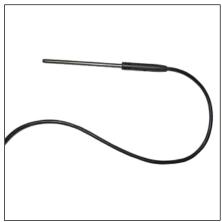
Термокомпенсатор представляет собой датчик температуры и применения соответствующим предназначен для преобразователем.
