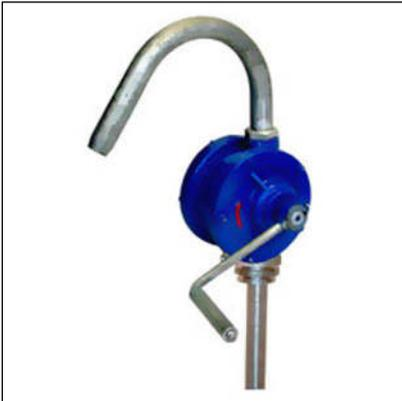
Ручной шиберный насос «РШ 25-5» предназначен для перекачки нейтральных жидких сред, обладающих смазывающей способностью и не содержащих механические примеси, из различных емкостей как, например, бочки.
