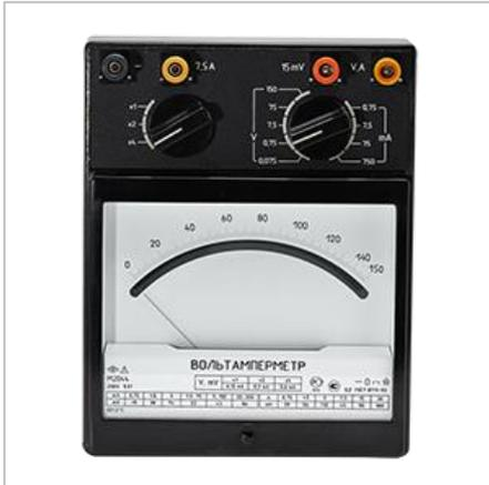
M2044 – многодиапазонный прибор магнитоэлектрической системы с подвижной частью на растяжках, со стрелочным указателем и равномерной шкалой длиной 150 мм, с антипараллаксным устройством.
