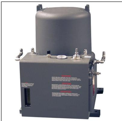
Поточный анализатор влажности газов **5000** предназначен для измерения влажности в сложных и загрязненных потоках, таких, например, как водородосодержащие газы риформинга. Анализатор определяет влажность в потоке газа, используя пьезокристаллический принцип измерения.
