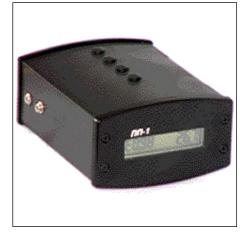
Пирометры портативные серии ПП-1 предназначены для бесконтактного измерения температуры поверхности объектов по их собственному тепловому излучению в диапазоне температур от -20 до +2000°С. Пирометры применяются для контроля состояния объектов и технологических процессов в различных отраслях, а также при проведении научных исследований.
