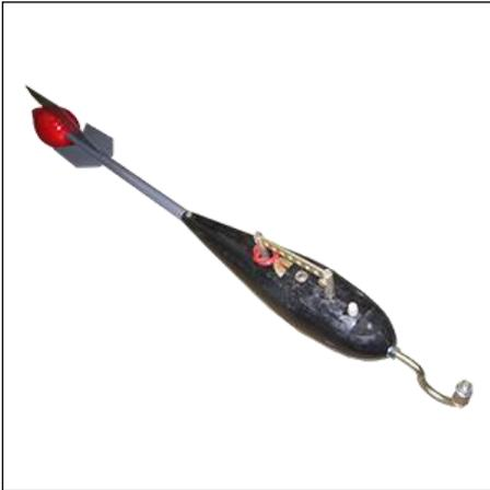
Грузы гидрометрические рыбовидные предназначены для производства гидрометрических работ на водотоках с большими скоростями.
