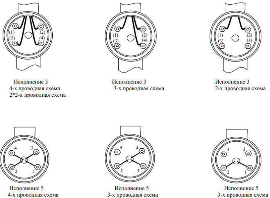
Рис. 7. Нумерация контактов на клеммных колодках
