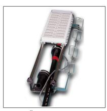
Бокс кабельный телефонный открытый **БКТО** предназначен для включения магистральных и распределительных кабелей и установки их в стандартные телефонные распределительные шкафы ШР и ШРП на посадочные места боксов типа БКТ-100х2 для расширения емкости имеющихся в эксплуатации шкафов или комплектования вновь монтируемых.
