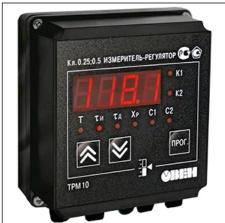
Терморегулятор ТРМ10 предназначен для измерения температуры или другой физической величины (веса, давления, влажности и т. п.), импульсного или аналогового управления нагрузкой в соответствии с пропорционально-интегрально-дифференциальному (ПИД) законом, а также для формирования дополнительного сигнала, который может быть использован для сигнализации о выходе параметра за установленные границы или для двухпозиционного регулирования.
