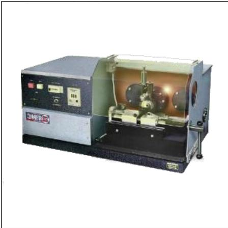
Машина предназначена для испытания проволоки из черных и цветных металлов и их сплавов на перегиб по ГОСТ 1579.
