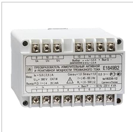
E1849 предназначены для линейного преобразования активной и реактивной мощности трехфазных трехпроводных цепей переменного тока в унифицированные выходные сигналы постоянного тока. Могут применяться в системах автоматического управления объектов электроэнергетики и различных отраслей промышленности, а также для контроля текущих значений активной и реактивной мощности.
