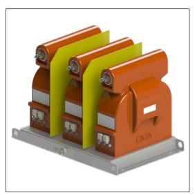
Трансформаторы напряжения 3х3НОЛ(П)-6(10) ΜΟΓΥΤ однофазными, индуктивными, трехили четырехобмоточными (исполнение 3НОЛ(П)-6(10)-4) электромагнитными устройствами С заземляемым первичной выводом «X» обмотки. По принципу конструкции – опорные, с литой изоляцией.
