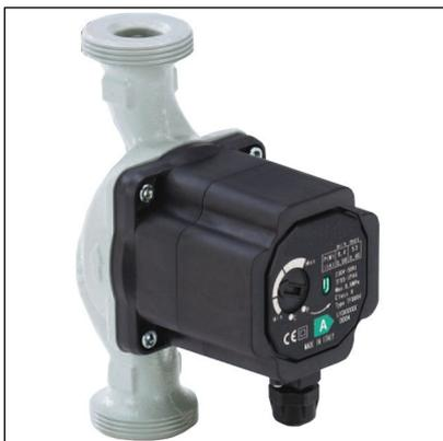
Циркуляционный насос **NCE IE** с переменной скоростью обладает высоким энергетическим КПД. Синхронный двигатель с постоянным магнитом, управляемый инвертором, обеспечивает высокую энергетическую эффективность, точные настройки рабочих характеристик, компактные размеры. Резьбовые соединения изготавливаются из латуни или чугуна по запросу.
