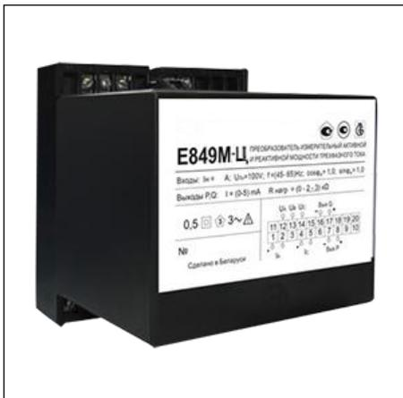
Измерительные преобразователи Е849М-Ц предназначены для линейного преобразования активной и реактивной мощности трехфазных трехпроводных цепей переменного тока в два гальванически развязанных между собой унифицированных аналоговых выходных сигнала постоянного тока и в цифровой сигнал с возможностью его передачи по интерфейсу RS-485 в протоколе MODBUS.
