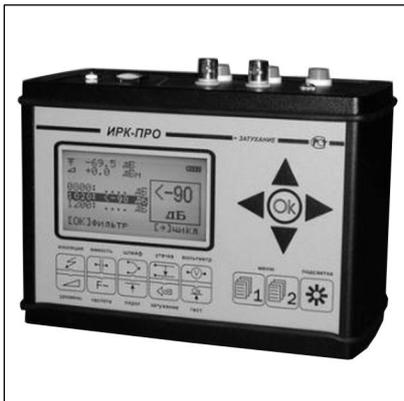
Прибор **ИРК-ПРО 20** предназначен для измерения сопротивления изоляции, шлейфа, омической асимметрии, электрической емкости всех типов кабелей связи, определения расстояния до участка с пониженным сопротивлением изоляции кабеля, определения места обрыва.
