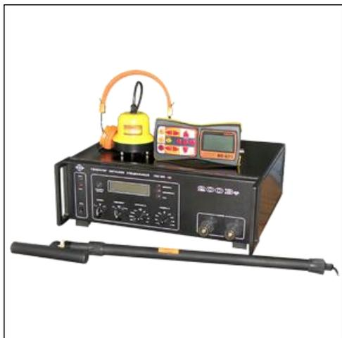
Комплект Атлет-ТЭК-227АН с мощным генератором предназначен для поиска подземных трасс, электрических кабелей и трубопроводов, а также определения глубины их залегания и мест повреждения. Генератор мощностью 200 Вт используется как источник тока синусоидальной формы звуковой частоты для определения мест повреждения силовых кабельных линий индукционным методом. Позволяет прибору производить трассировку с высокой дальностью и осуществлять высокоэффективный поиск мест повреждения кабелей.
