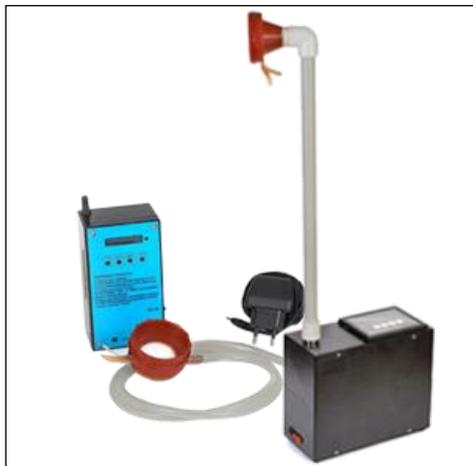
Прибор для отбора проб воздуха ПА-20М предназначен для измерения заданного объема воздуха при отборе разовых и среднесменных проб воздуха атмосферы и рабочей зоны на загрязненность.
