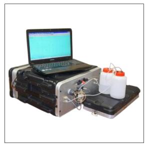
Хроматограф жидкостный ионный «Стайер» представляет собой устройство, полностью смонтированное в специализированном кейсе и реализующее возможность работы как в одно-, так и в двухколоночном варианте ионной хроматографии (ИХ).
