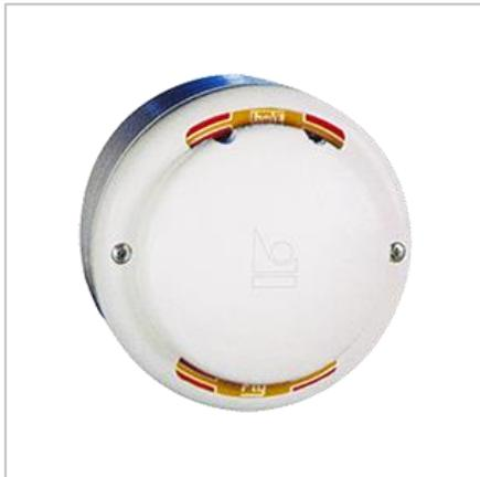
Датчики FLY со сменным модулем (сенсором) предназначены для работы в системах непрерывного контроля горючих газов. Имеют пороговый аналоговый выход 4...12...20 мА, соответствующий концентрации контролируемого газа как воздух – предтревога - тревога. Применяются в промышленных котельных, химических лабораториях и в бытовом секторе.
