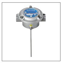
Взрывозащищенный тепловой программируемый извещатель ИП101-07ем применяется в системах пожарной сигнализации и предназначен для обнаружения возгорания, сопровождающегося повышением температуры внутри контролируемого пространства, и выдачи электрического сигнала при повышении температуры окружающей среды выше заданного значения, путем размыкания или замыкания цепи шлейфа пожарной сигнализации.
