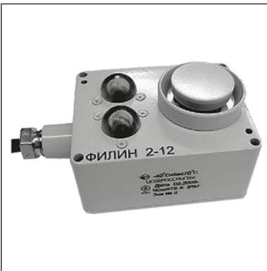
**Оповещатели ФИЛИН-2** - свечение одноцветное или двухцветное, звуковое давление не менее 105 дБ, работают от источника постоянного тока напряжением от 10,8 до 28,0 В или от сети напряжением от 187 до 243 В переменного тока.
