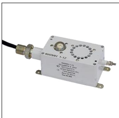
**Оповещатели ФИЛИН-1** - свечение одноцветное, звуковое давление не менее 105 дБ, работают от источника постоянного тока напряжением от 10,8 до 28,0 В или от сети напряжением от 187 до 243 В переменного тока.
